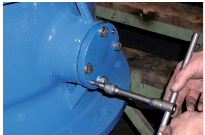
рис. 15: Замена уплотнения - шаг 3
