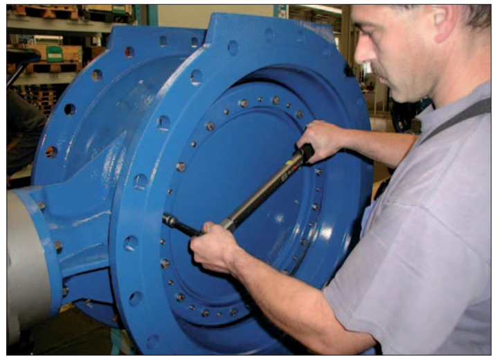
рис. 18: Затягивание болтов на предохранительном кольце
