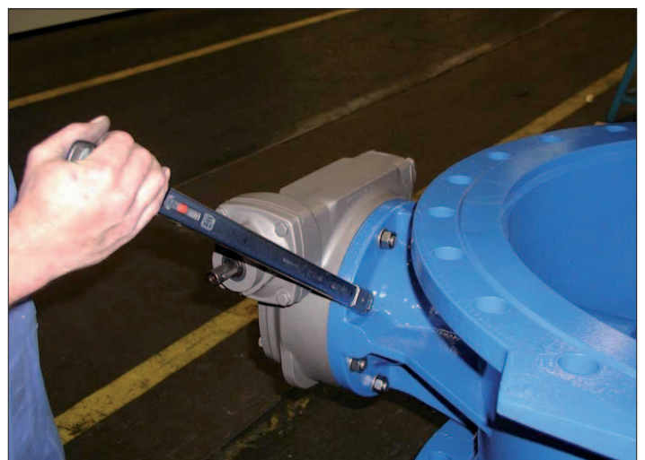
рис. 20: Затягивание фиксирующих болтов редуктора
