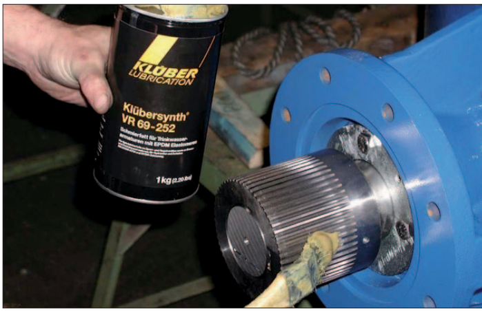
рис. 16: Замена уплотнения - шаг 4
