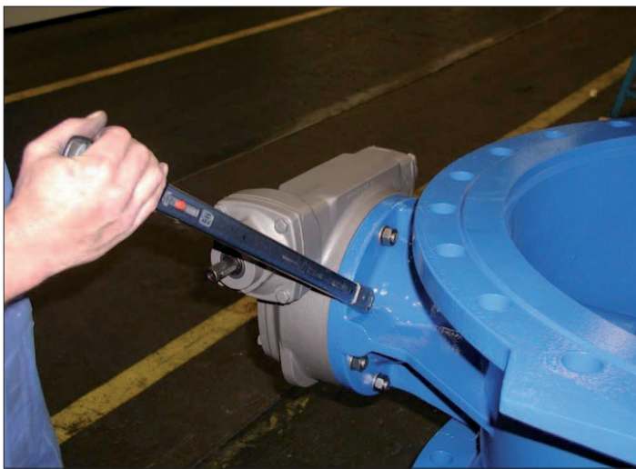
рис. 17: Замена уплотнения - шаг 5
