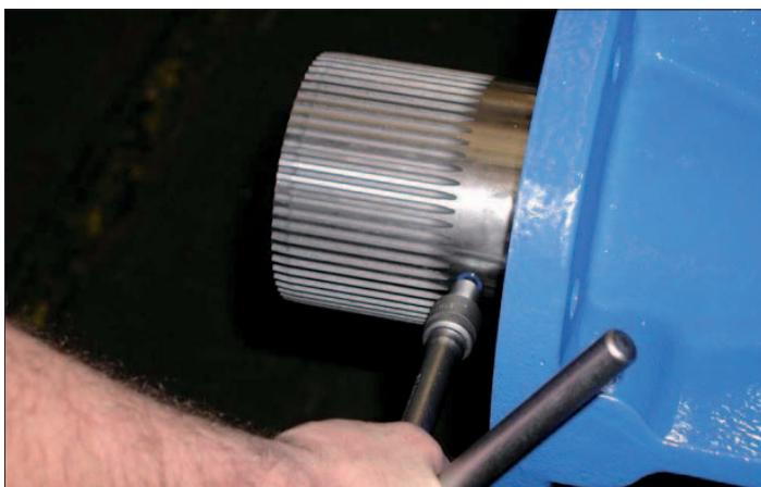
рис. 13: Замена уплотнения - шаг 1
