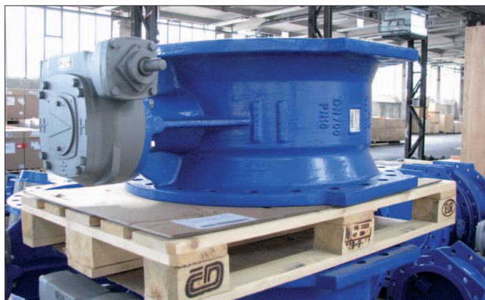
рис. 1: Положение для транспортировки – на входном фланце
